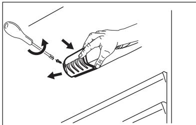
3. Замените использованную лампу новой лампой такой же мощности и предназначенный специально для бытовых приборов (максимальная мощность указана на плафоне).
